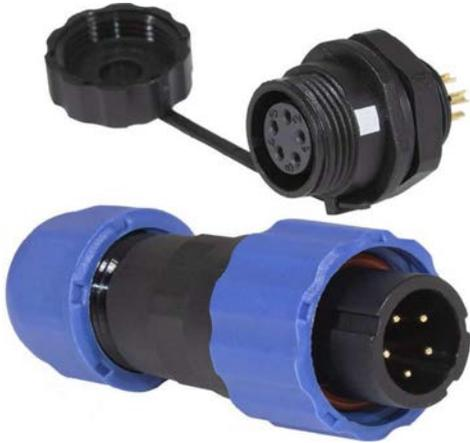
Герметичный разъём (комплект) с заглушкой SZC13 5P-M-FB, вилка-розетка, 5 контактов, диаметр входящего кабеля 6,5 мм, IP68, 5 А, 250 В, является пылезащищенным и влагозащищенным. Герметичный разъём соответствует высокой степени защиты, что гарантирует работу разъемов при длительном погружении в воду (более 30 минут) на глубину больше 1 м.
